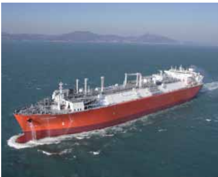
Excelsior, het eerste LNGRV-schip (Liquified Natural Gas Regasification Vessel))
